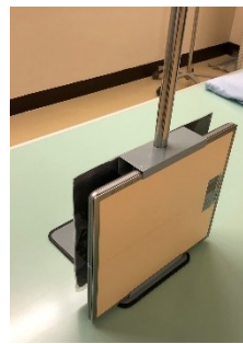
図 7. 支柱後方への遮蔽体の設置
